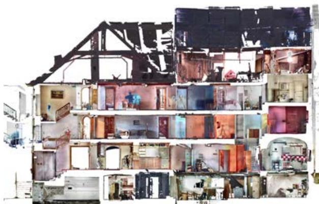
Eintauchen in den virtuellen Raum mittels einer Punktwolke. Querschnitt durch das bestehende 'Hotel Scaletta'.
